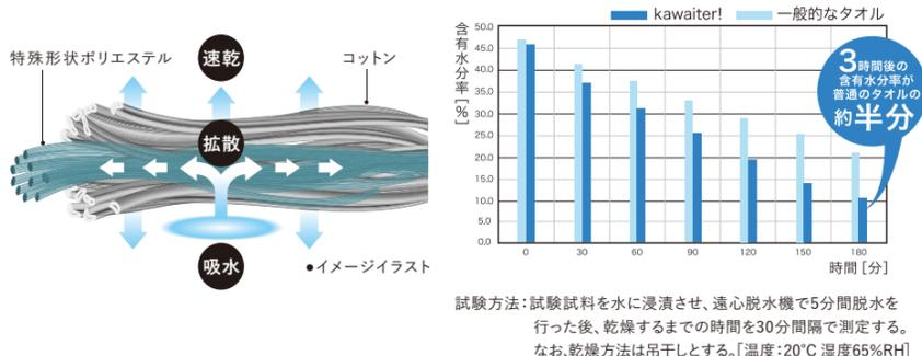
試験方法:試験試料を水に浸漬させ、遠心脱水機で5分間脱水を行った後、乾燥するまでの時間を30分間隔で測定する。なお、乾燥方法は吊干しとする。[温度:20°C 湿度:65%RH]
